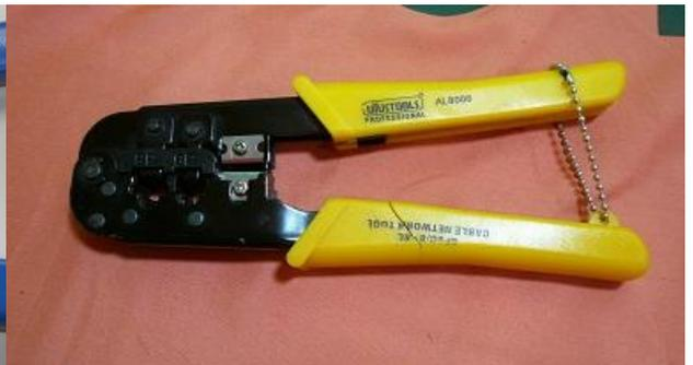
*Figura 1.2 El alicate Crimpeador es también usado para cortar y desencapar los cabos UTP.*
