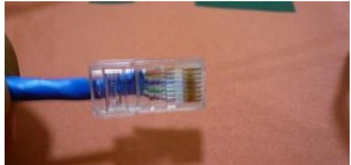
*Figura 1.8 La capa de plástico queda sujeta dentro del conector.*
