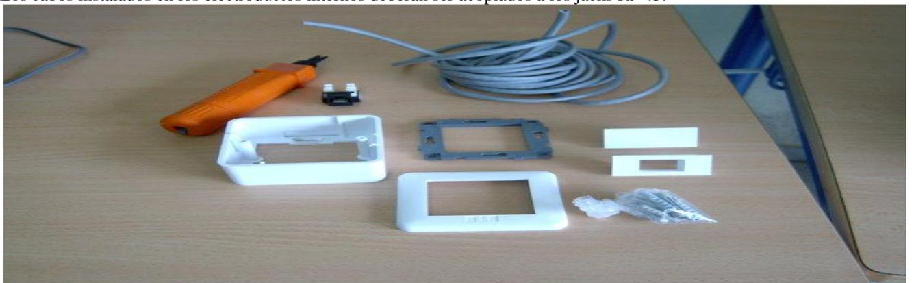
*Figura 1.14 Elementos para montar una roseta.*
