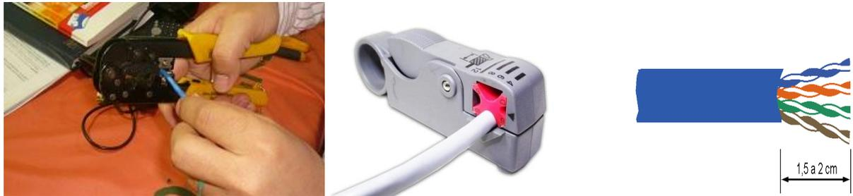
*Figura 1.3 Sacando la capa de los cables.*
